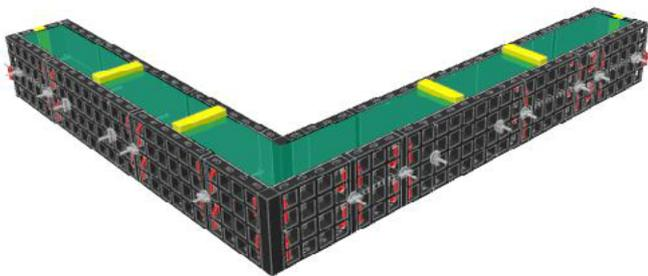
Beispielhafte Grundrissplanung für ein Streifenfundament aus dem QuickSolve Planer (b = 40 cm, h = 60 cm)
